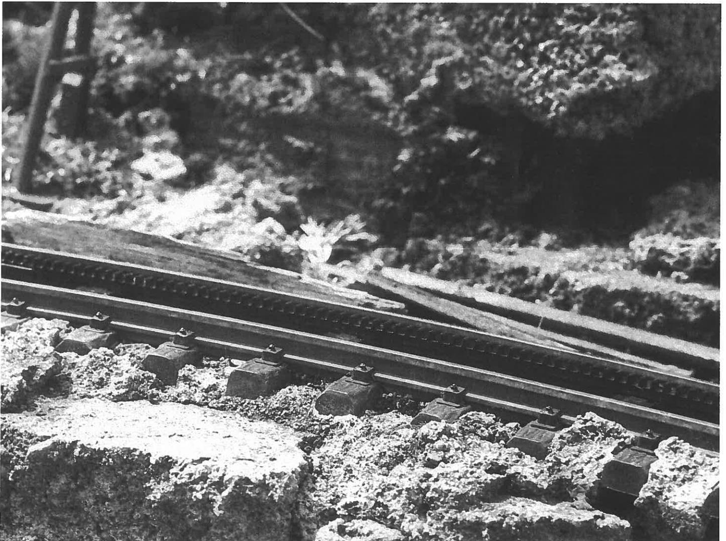
Nahtlos fügt sich die Zahnstange in das LGB-Gleis ein.
